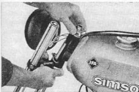
Oberen Gabellauftring lösen und komplette Vordergabel aus dem Stirnrohr des Rahmens nehmen.
