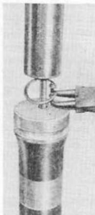
Abdeckblech über die Gleitrohröffnung schieben und Sicherungsring 25 montieren.
