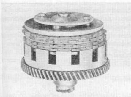
Der Zusammenbau erfolgt in umgekehrter Reihenfolge der Demontage, wobei wiederum das Druckstück als Hilfswerkzeug zu benutzen ist. Das Entspannen der Tellerfeder zur Herstellung der richtigen Funktionslage der Reibscheiben geschieht jedoch erst nach dem Einlegen des Kupplungspaketes in den Korb des Kupplungszahnrades, das bereits auf der Kupplungswelle steckt.
